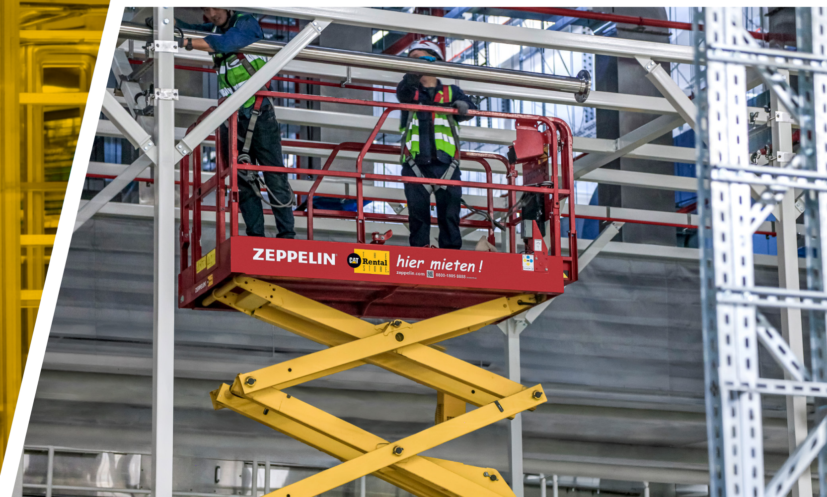
Die Scherenbühne Skyjack SJ3219 hat eine Arbeitshöhe von rund 7,8 Metern
