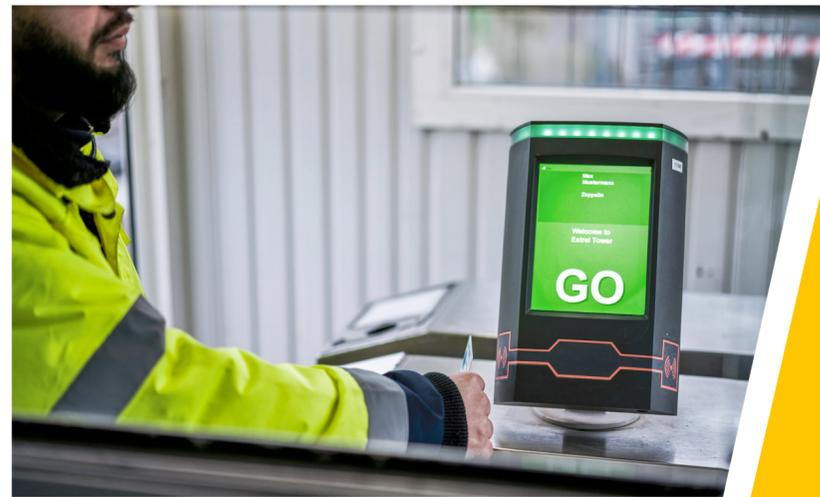
InSite 4.0: Personen erhalten einen Baustellenausweis mit integriertem RFID-Chip und können sich anschließend selbstständig ein- und auschecken
